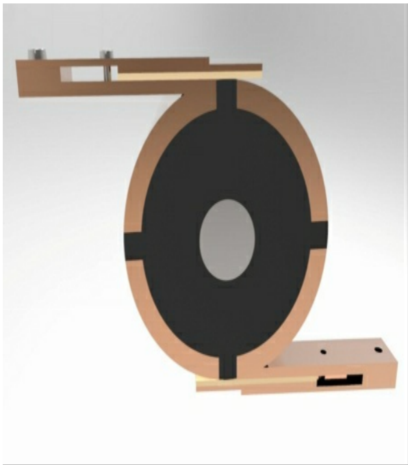
Ilustración 14 - El aislante de mica se muestra en colores amarillo y cobre en medio de las escobillas, solo se quería hacer notar que en el diseño original Tesla parece hacer dividido el aislante en dos mitades, seguramente teniendo en cuenta las propiedades mecánica
