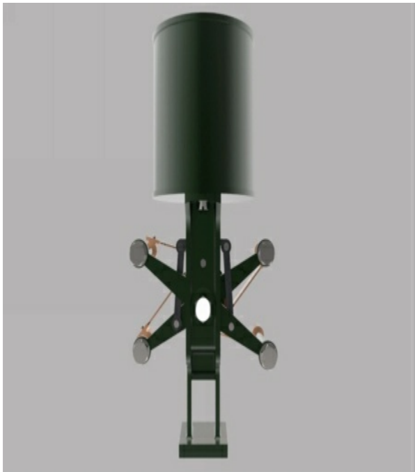
Ilustración 20 - Vista posterior de la máquina del lado contrario a las escobillas, las extensiones verdes que forman la X se mueven de arriba a abajo (Zapata, 2015)
