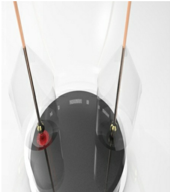
Ilustración 37 - En esta imagen se muestra una ampliación de la patente donde se muestran en color cobre los filamentos "G", las uniones de vidrio "D" y la unión eléctrica "E" cuyo material puede ser polvo de bronce según la sugerencia de Tesla
