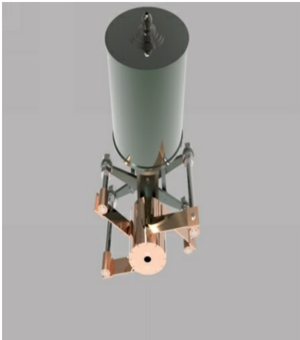
Ilustración 23 - Vista superior del aparato donde se puede visualizar el cilindro que contiene el solenoide, las escobillas en color cobre, el cilindro que forma parte del dinamo y las extensiones en color verde y plateado (Zapata, 2015)
