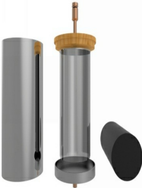
Ilustración 61 - Despiece del condensador eléctrico, de izquierda a derecha, contenedor
