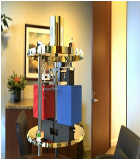
Ilustración 1 - - Lámpara de arco eléctrico - sin los electrodos de carbono (Zapata, 2015)
