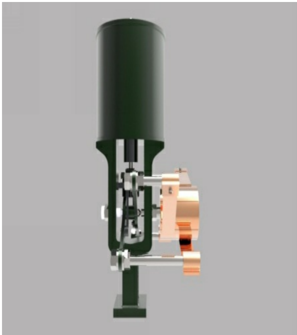
Ilustración 21 -El cilindro de color verde contiene un solenoide que hace subir y bajar un cilindro de color negro en el centro del dispositivo, las extensiones que llevan el movimiento a las escobillas, desde el cilindro negro pasando también por las extensiones verdes que se muestran en X en la anterior Ilustración (Zapata, 2015)
