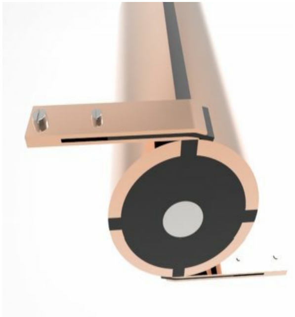
Ilustración 15 - Escobillas con aislante de asbesto, Tesla utilizó en su diseño dos tamaños de tornillos uno para la fijación y el otro para el ajuste (Zapata, 2015)
