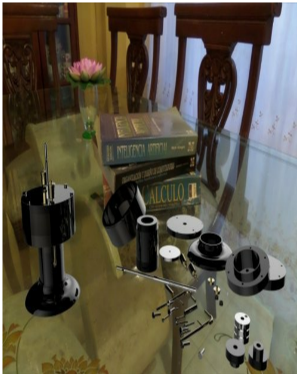
Ilustración 58 - Dos motores, en la izquierda hay uno armado y en la derecha otro idéntico desarmado mostrando todas sus partes
