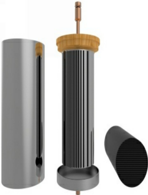
Ilustración 62 - Despiece del condensador eléctrico en la que se le ha dado un giro al
