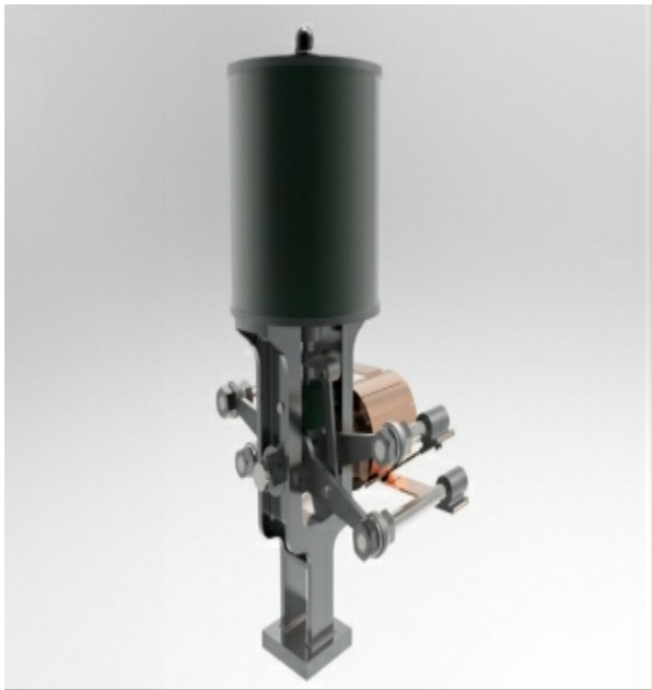
Ilustración 17 - La imagen es el modelo de la patente y en color verde es representado el contenedor del solenoide, en gris oscuro la base y los enlaces a las escobillas, en color cobre la escobillas y el eje de la dinamo que será objeto de la regulación de la corriente (Zapata, 2015)
