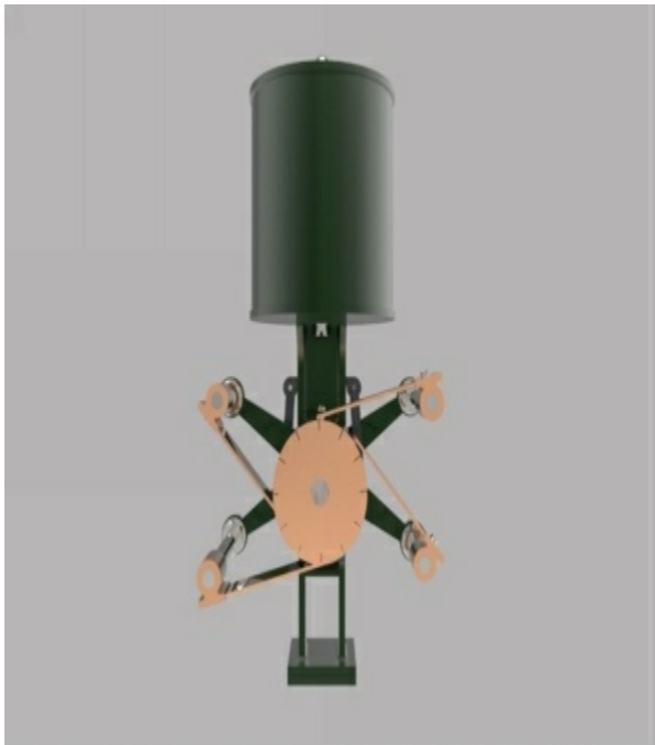
Ilustración 22 - Vista frontal que corresponden con la figura 1 de la patente genuina, el cilindro del cual solo se ve la cara circular muestra la relación de las escobillas con dicho cilindro estas escobillas se mueven de arriba abajo sin tocarse (Zapata, 2015)
