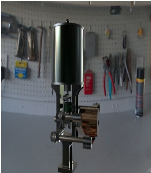
Ilustración 25 -Así se vería el regulador montado en un taller de mecánica, el cilindro de color cobre corresponde con una parte del dinamo y Tesla lo muestra para indicar la posición relativa con respecto a dicho dinamo (Zapata, 2015)
