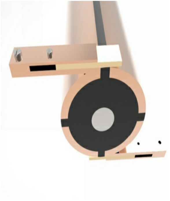
Ilustración 16 - Note los dos tamaños de tornillos el de más diámetro es para la fijación y el más pequeño para el ajuste, así mismo observe que es mica lo que se utiliza como aislante y representada en color amarillo (Zapata, 2015)
