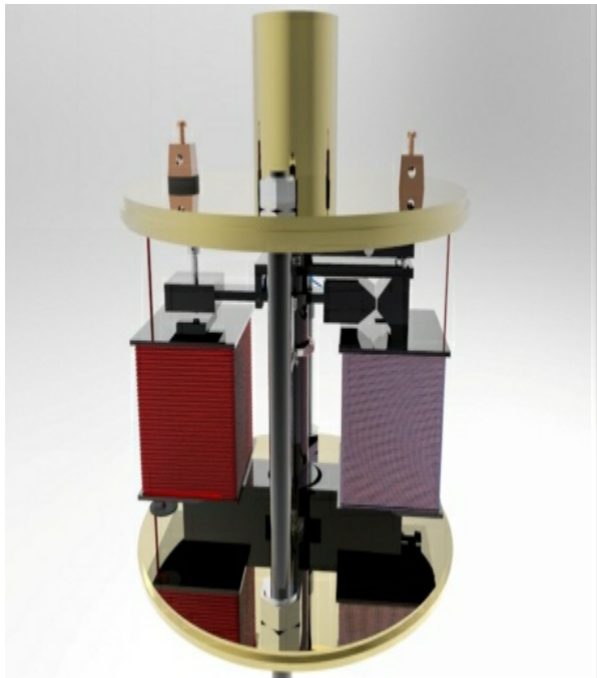
Ilustración 5 - Esta imagen corresponde con la figura 1 de la patente 335786, se aprecian los conectores superiores que son de cobre a donde llegaban los dos conductores (Zapata, 2015)
