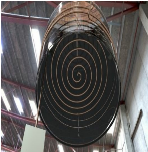
Ilustración 67 - Vista inferior modelo patente 685012 - se aprecia la bobina en espiral plana y su conexión a tierra que es representada por la placa cuadrada.
