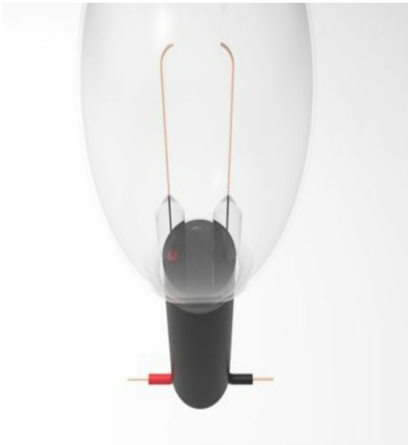
Ilustración 36 - En esta imagen se visualiza en color cobre los filamentos "G", se aprecian las dos uniones de vidrio "D", observe en color rojo el final del aislamiento del alambre C mostrado levemente en un círculo rojo en la parte superior
